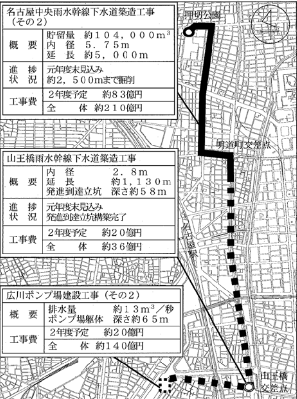
名古屋中央雨水調整池等の進捗状況
