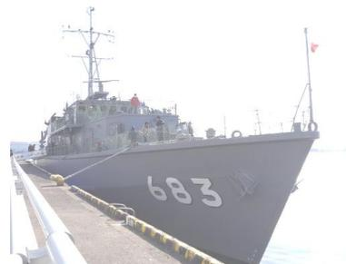
ため新型の情報処理装置、機雷探知器、機雷処分具及び自動操艦装置を搭載。また、作戦海面における静粛化（音響管制）の強化のために電気推進機を2基搭載。掃海艇は護衛艦や一般商船とは違って、磁気を感じて爆発する機雷（磁気機雷）から艇の安全を確保するため、船体は、木製、エンジン等はアルミ合金等を使用することにより、磁気を帯びないような設計となっている。
