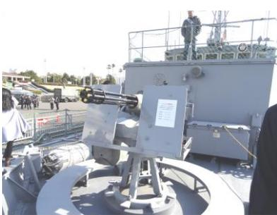
浮いた機雷を破壊する 20 ミリ砲
