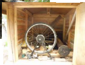
ミニ水車による発電装置（上と右）
