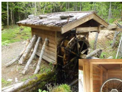
ミニ水車による発電装置（上と右）
