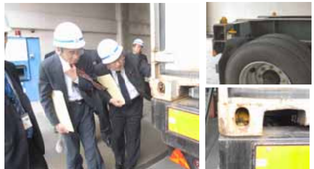
コンテナターミナルでトレーラーの状況を調査する市議団（左上） コンテナを積み込む前のトレーラーの爪（右上） コンテナを積み込みロックされた爪（右中） コンテナ固定用の装置はロックレバー（ノッチ）で90度回転することで、コンテナがはずれないようになっている（下の3連写真）
