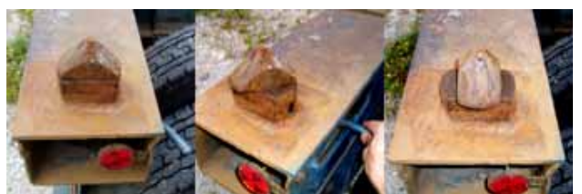
コンテナターミナルでトレーラーの状況を調査する市議団（左上） コンテナを積み込む前のトレーラーの爪（右上） コンテナを積み込みロックされた爪（右中） コンテナ固定用の装置はロックレバー（ノッチ）で90度回転することで、コンテナがはずれないようになっている（下の3連写真）
